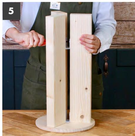
脚の隙間に 2 つ目の〔脚固定パーツ〕を入れ、全体の 1/3 程度の場所に〔脚用ビス〕でネジ止めします。
