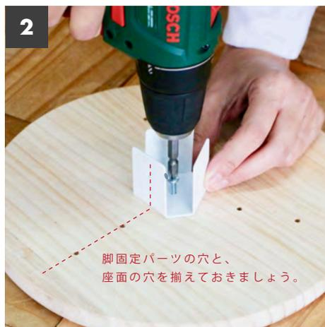
〔脚用ビス〕で〔脚固定パーツ〕を、〔座面〕の中心にネジ止めします。
