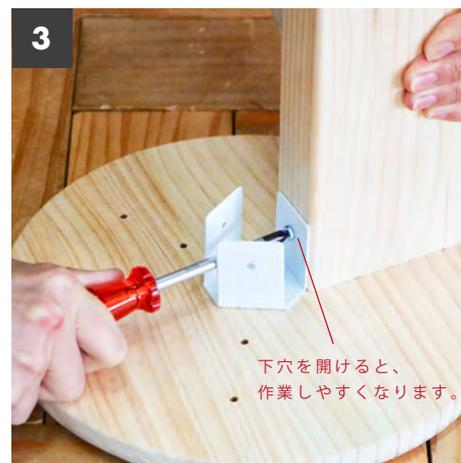
続いて、〔脚用ビス〕で〔脚固定パーツ〕と〔2x4 材〕をネジ止めします。
