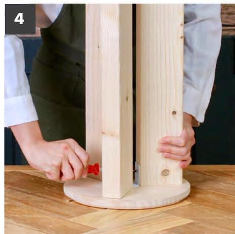
残り 2 本も同様に、〔脚用ビス〕でネジ止めします。(長いビットがあれば電動ドライバーで締めて頂いても大丈夫です。)
