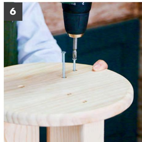
最後に、〔座面用ビス〕で座面の上から 6 本固定したら完成です！
